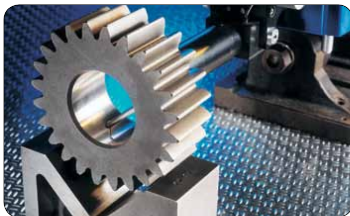
Gli errori di forma causano problemi di montaggio, inefficienza del funzionamento e guasto prematuro dei componenti
