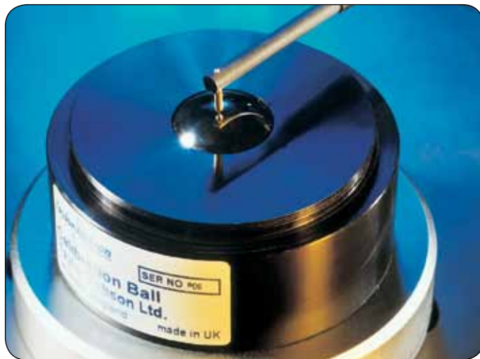
Eseguito la calibrazione con una sfera è possibile verificare la condizione dello stilo e la linearità e l'intervallo del misuratore
